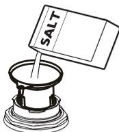
Placez l'entonnoir fourni sur l'ouverture du réservoir de sel, puis versez 1,5 kg de sel dans le réservoir.
